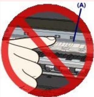
Wenn Sie diese Teile mit dem Papier oder den Händen berühren und Kratzer oder Flecken darauf hinterlassen, kann das Gerät beschädigt werden.
