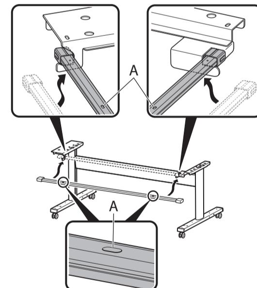
**7** プリンター本体をスタンドに置くときの位置合わせ用の目印を確認します。目印は、バスケットを使用する場合 (7-a) と TX シリーズでスタッカーを使用する場合 (7-b) で異なります。それぞれの手順へ進んでください。
