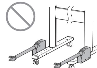
**2** バスケットアームを 2 個のバスケットアーム用 M4 六角ビスでスタンドに固定します。M4 六角レンチを使ってしっかりと固定します。
