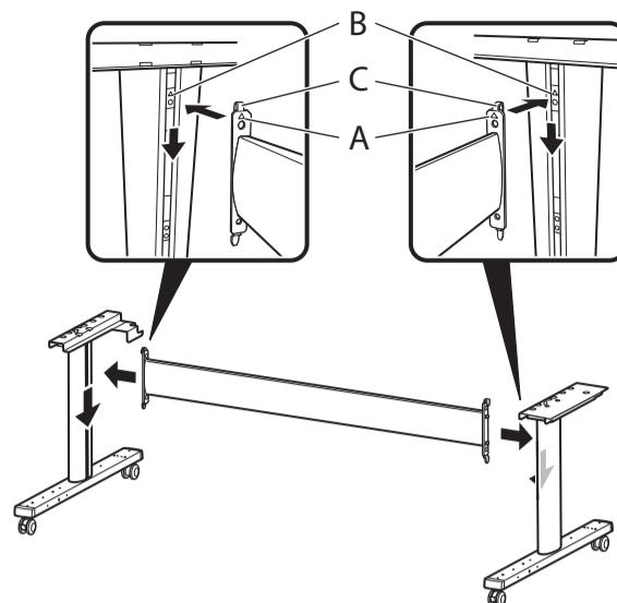
**4** スタンドステーを左右各2個のM8六角ビスで固定します。M8六角レンチを使ってしっかりと固定します。
