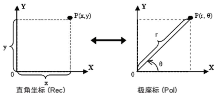
Shift Pol: 将直角坐标  $(x, y)$  转换为极坐标  $(r, \theta)$ ; 按下
